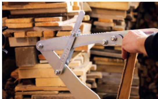
Der verstellbare Anschlaghebel muss an die Länge des Scheites angepasst werden, um die volle Kraftwirkung zu erreichen.
